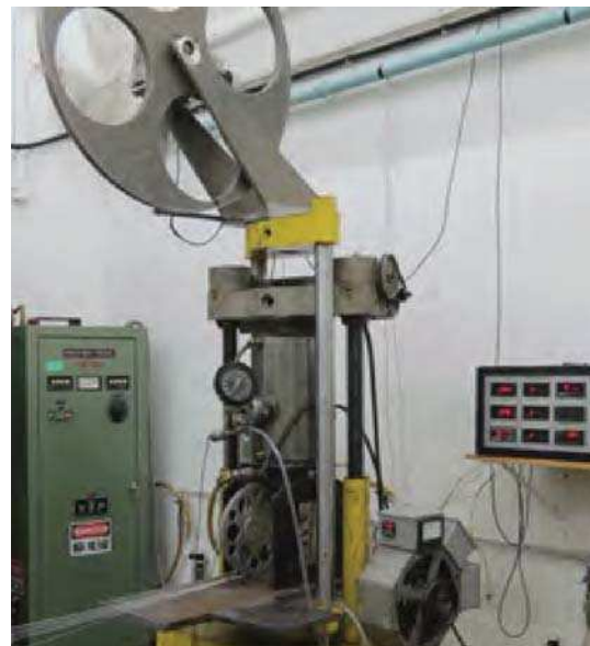
8. ábra. A szálköteg áthúása a kompozithuzal gyártási folyamatában
