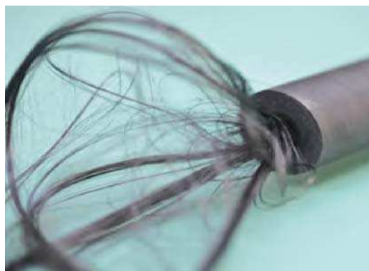
3. ábra. A szénszálköteg bolyhozódása a grafitból készült bemeneti kapu bejáratánál
