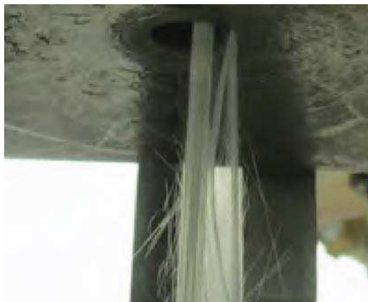
5. ábra. A bemeneti kapuba befűzött, áthúzásra előkészített CeraFib 99 szálköteg
