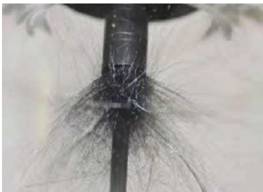
3. ábra. A szénszálköteg bolyhozódása a grafitból készült bemeneti kapu bejáratánál
