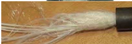
6. ábra. A már a bemeneti kapu előtt szakadozó, majd elszakadt CeraFib 99 szálköteg
