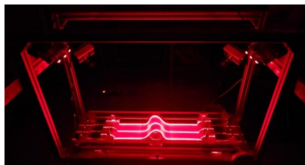
17. ábra. A Sylvie 3D Bending Tester mérés közben
