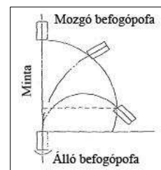
13. ábra. A KES hajlítóvizsgálat elve
