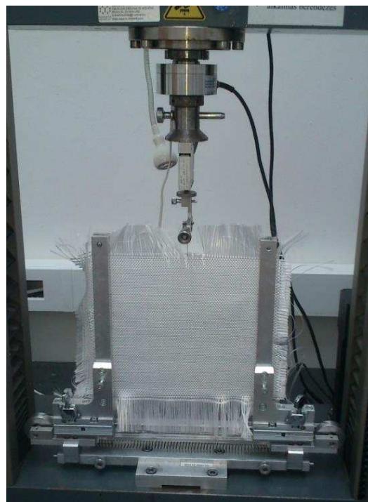
12. ábra. Befogó készülék fonalkihúzó vizsgálatához való középső befogóval
