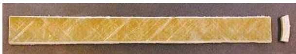
2. ábra. Üvegszál erősítésű poliészter kompozit csőből kivágott tengelyirányú próbatest és annak keresztmetszete
