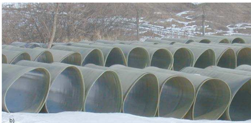
1. ábra. a – Száltekerceselési technológia elvi vázlata, b – száltekerceseléssel készült csatornacső bélések
