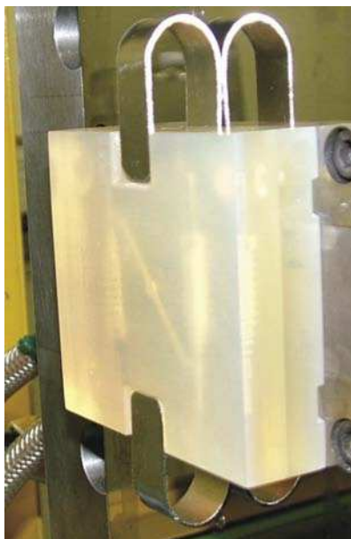
10. ábra. Fröccsöntő gépre felfogott, összeszerelt fröccsöntő szerszám [21]
