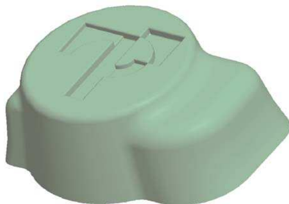
3. ábra. A tervezett vákuumformázó szerszám CAD modellje
