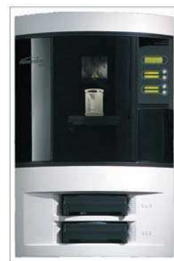
4. ábra. Stratasy Dimension FDM gyors prototípusgyártó berendezés
