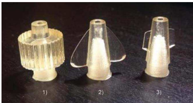
5. ábra. Első generációs luer csatlakozók
