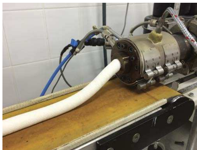
5. ábra. Az expandált PLA csőgyártás folyamata
