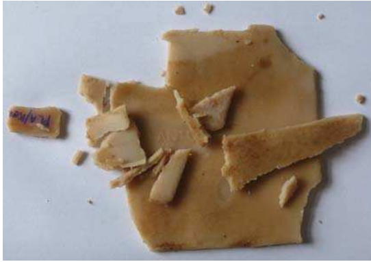
20. ábra. Komposztált 30m% keményítő töltésű PLA próbatest 2 nap elteltével
