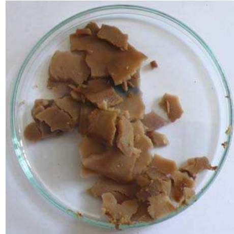
23. ábra. Komposztált 30m% keményítő töltésű PLA próbatest 14 nap elteltével
