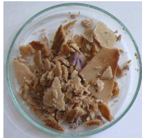
24. ábra. Komposztált 15m% cellulóz töltésű PLA próbatest 2 nap elteltével
