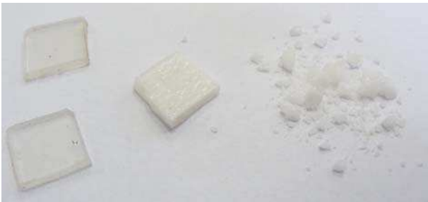
4. ábra. PLA próbatestek elaprózódása 144 óra után (80°C). Bal oldali próbatestekről a kép a bontás előtt, a középső, valamint jobb oldali próbatestek a bontás után készültek
