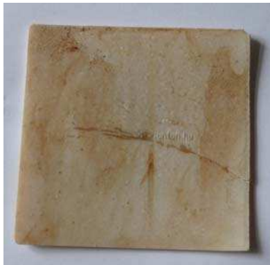
21. ábra. Komposztált 15m% cellulóz töltésű PLA próbatest 2 nap elteltével
