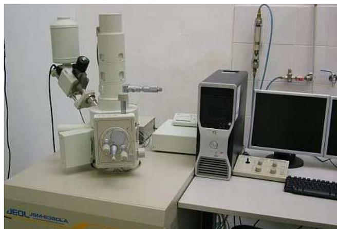
**2. ábra. Jeol JSM 6380 LA típusú pásztázó elektronmikroszkóp (SEM) energiadiszperzív röntgenspektroszkóp (EDS) feltétellel**
