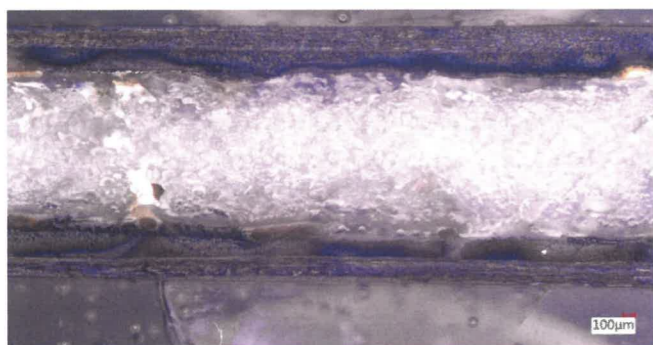
△ 9. ábra: 1 m/m%-os habosítószer aránnyal rendelkező habmag optikai mikroszkópos képe
