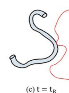
1. ábra: A polimer molekulák reptációs mozgásának szemléltetése: (a) a kezdeti időpillanatban, (b) a mozgás elindulta után és (c) a reptációs idő elteltével
