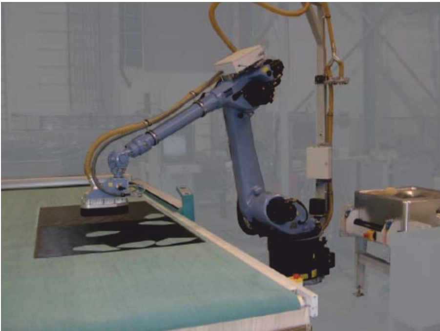
4. ábra. Robotkar pakol a CNC vezérelt vágóasztalról [17].
