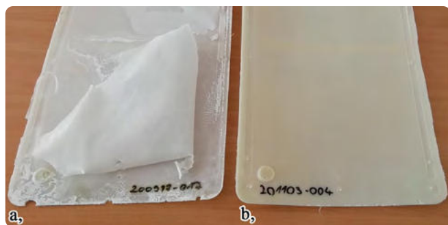
5. ábra: A szerszám teljes (a) és részleges (b) nyitásával készített minták felülete
