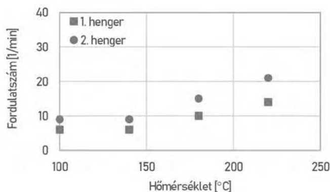
2. ábra. A hengerek fordulatszáma a hőmérséklet függvényében 1,5-szeres frikció esetén
