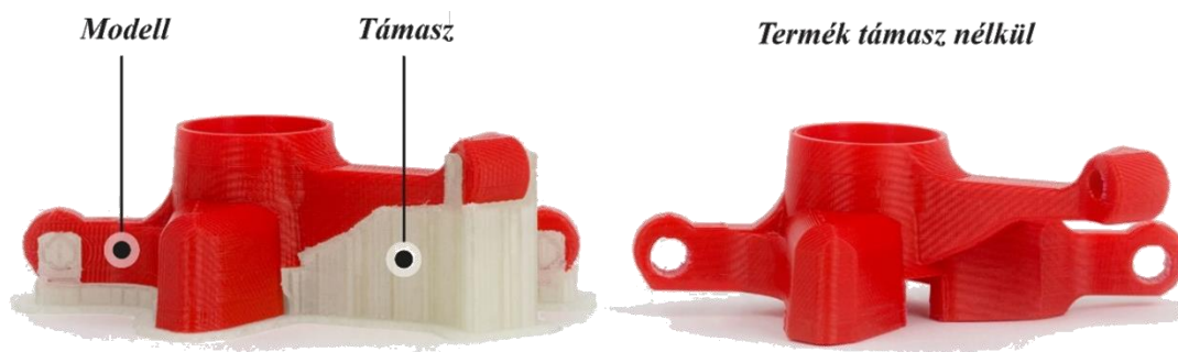
8. ábra Modell gyártás közbeni megtámasztása
